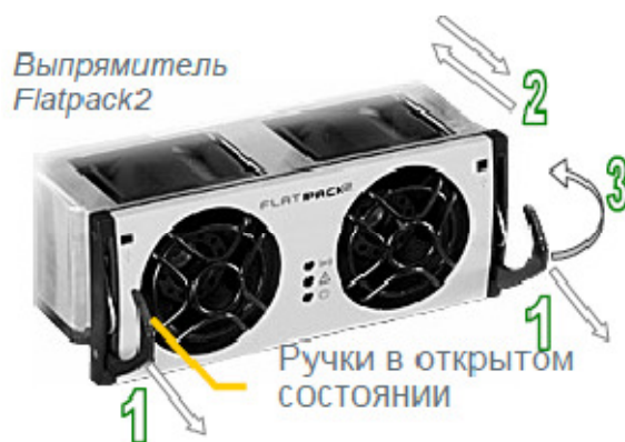
Рисунок 3. Извлечение выпрямителя.
