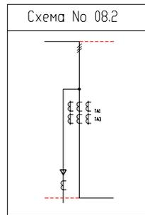
Шинный переход с ТТ и кабельным вводом
