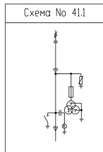
Кабельный ввод с разводящей перемычкой, заземлителем и ТН
