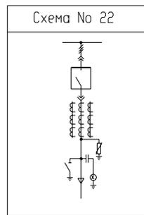
Кабельный ввод с выключателем, заземлителем и ТТ
