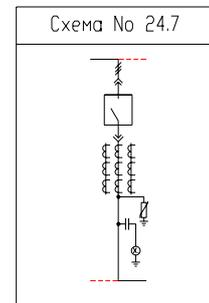
Шинный переход с выключателем и ТТ
