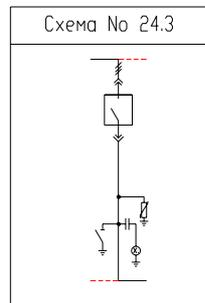
Шинный переход с выключателем и заземлителем
