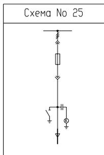
Кабельный ввод с разводящей перемычкой с предохранителями и заземлителем
