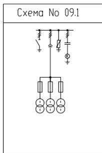
Группа однофазных ТН и заземлитель сборных шин
