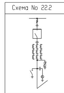
Задний шинный ввод с выключателем, заземлителем и ТТ
