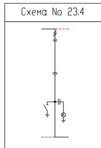
Шинный переход с разводящей перемычкой и заземлителем
