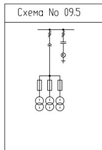
Трехфазный ТН и заземлитель сборных шин
